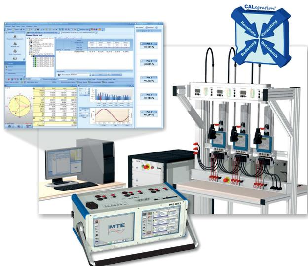
Die Philosophie von CALegration® besteht darin, dass alle grundlegenden Prüfelemente (Verwaltung, Datenbank, Bedienung, Resultate) in einer einzigen Software vereint sind und mit tragbaren sowie auch mit stationären Prüfmitteln von MTE verwendet werden können.
